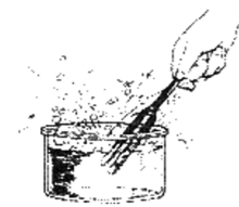
用发声的音叉接触水面时, 水面水花四溅
