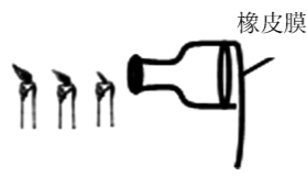
对着点燃的蜡烛火焰 敲击橡皮膜, 蜡烛熄灭
